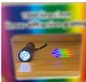
8 Blick durch die Gitterfolie. Das Licht der Taschenlampe wird in seine Lichtfarben zerlegt. Die einzelnen runden Lichtsender der Taschenlampe siehst du durch das Gitter in blau bis rot.
