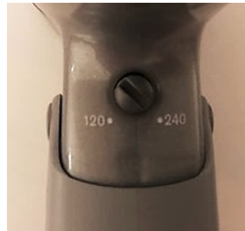
Umschalter für die Netzspannung auf einem Föhn
